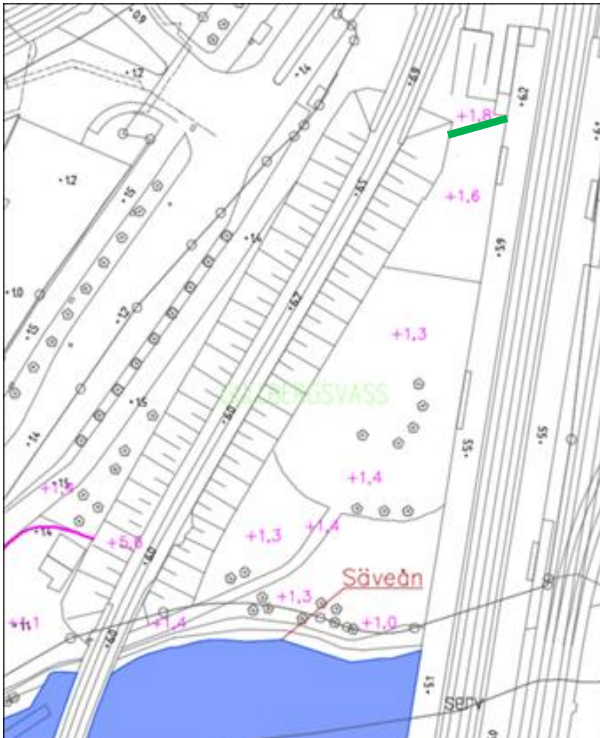
Figur 6. Grönt strecket visar ungefärlig placering av föreslaget mobilt/temporärt högvattenskydd.
